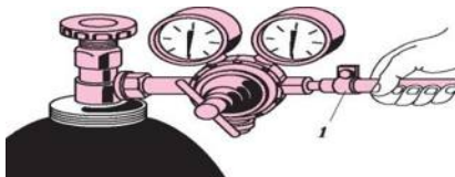
Сур. 10.5. Шланганы (рукаваны) газоредукторға бекіту:1 — қамыт
