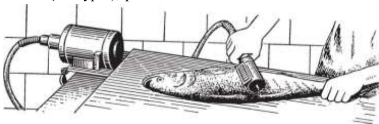
2.2 сурет. РО-1 электр қырғышпен балық қабыршақтарын тазалау
