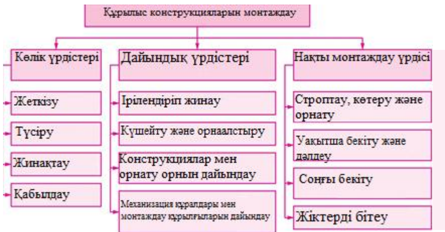
6.3-сурет. Құрылыс конструкцияларын монтаждау процесінің құрамы
