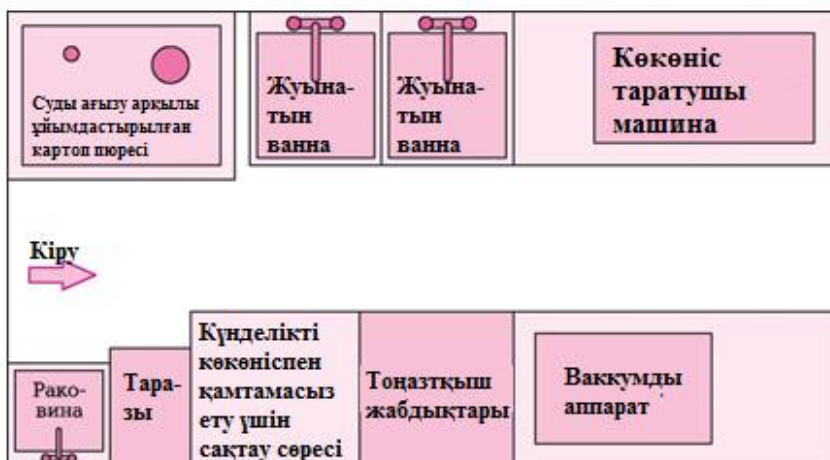
3.2 сур. Шағын айналымы бар тамақтану кәсіпорындарындағы көкөніс цехінің сызбасы
