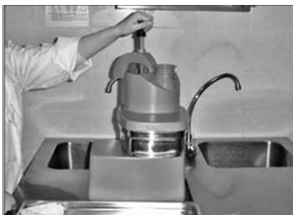
3.12 сур. CL50 көкөніс турағыш машина жұмысының тәртібі:
