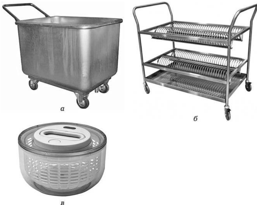
3.8 сур. Көкөністік шикізатті, жартылай фабрикаттарды тасымалдап және оларды кептіруге арналған құрылғы
