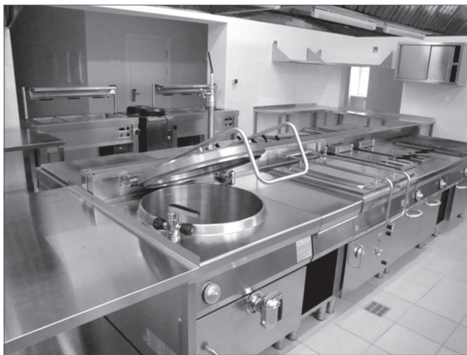
2.22 - сурет. Секционное модульное оборудование и пищеварочный котел для варки компотов, киселей, гарниров к сладким блюдам в горячем цехе
