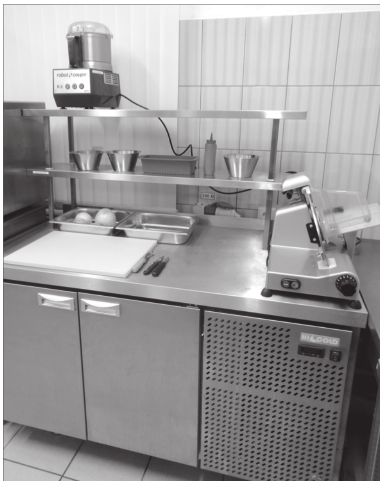
Сурет 2.10. Салқын тәтті тағамдарды дайындау бойынша жұмыс орнын ұйымдастыру (тоңазытқыш сөресі, үстел үсті құралдарын, құрал-саймандарды, куттер, слайсер, жемістерді кесуге арналған тақтай, гастроидыс, пышақтар, құрал- жабдықтар сақтау сөрелері бар үстел)
