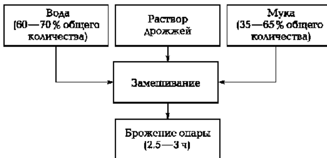
6.2. сур. Ашытқы қамыр дайындаудың технологиялық сызбасы
