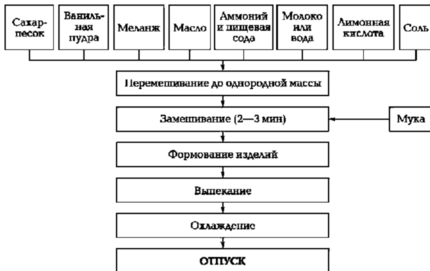
Сур. 6.9. Тәтті тұщы қамырдан өнімдерді жасаудың технологиялық сызбасы
