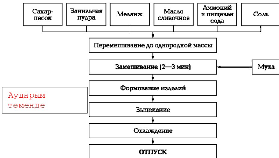
Сур. 6.10. Үгілмелі қамырдан өнімдерді дайындаудың технологиялық сызбасы
