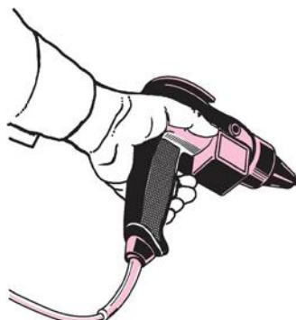
4.77-сурет. Бұрағыш көмегімен беттерді бұрандалы шегелермен бекіту
