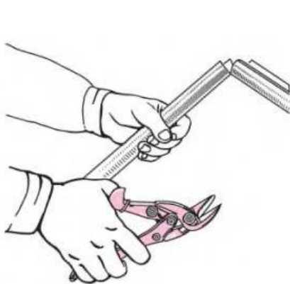
4.76-сурет. Профильдерді кесу
