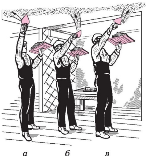
Сурет. 4.25. Ерітіндіні сылақ күрекшесімен төбеге лақтыру:
