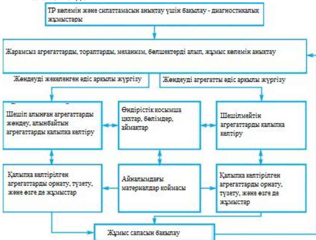
34.1 сурет Көліктерді ағымдық жөндеу процессінің схемасы.
