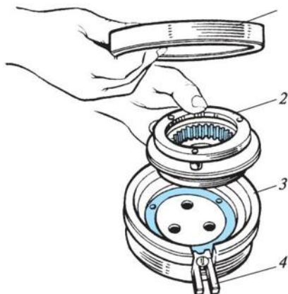
19.24 сурет. Синхронизаторды сұққыларды радиусты шегелеуге арналған арнайы жабдыққа орнату:
