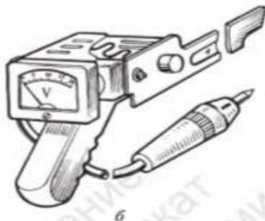
18.2. сурет. Жүктеме ашасы (а) және Э-107 аккумуляторлық сынамасы (б)
