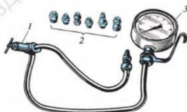
16.1.сурет Отын сорғысын тексеруге арналған НИИАТ-527Б құрылғысы:
