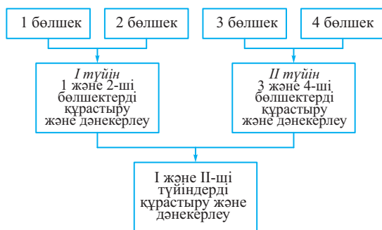
4.4 сур. Конструкцияның параллельді-жүйелі құрастыру және дәнекерлеу сызбасы
