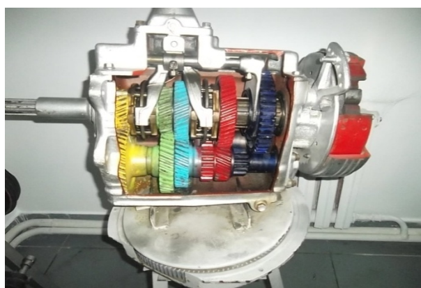
10-сурет. ЗИЛ жүк автомобилінің беріліс қорабының қимасы күшейткішінің қимасы
