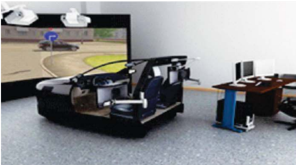
15-сурет. Форд Фокус автотренажері: панорамдық экраны 180 гр. бұрышты бақылайды
