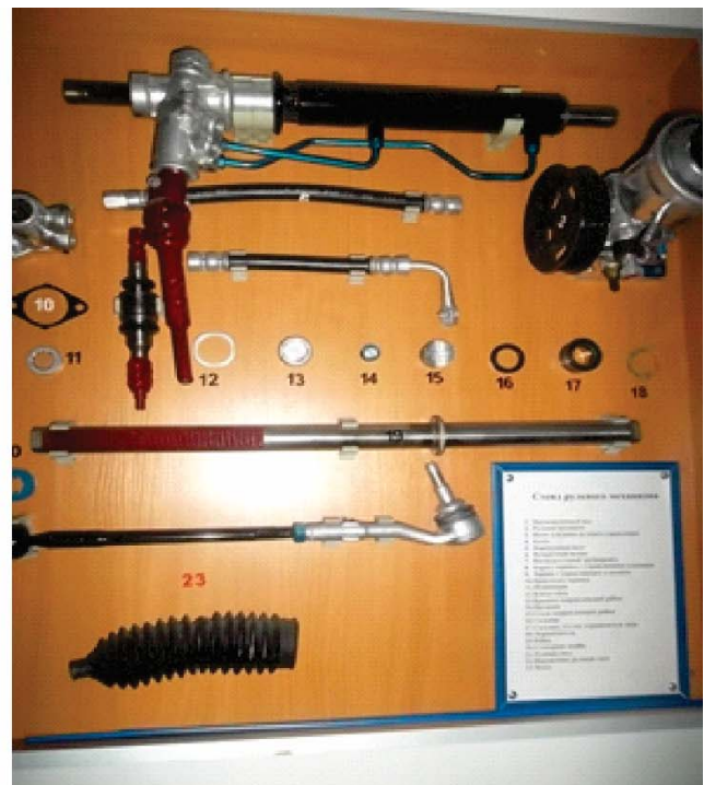
12-сурет. Бөлшектелген гидравликалық рульдік механизмнің бөлшектері
