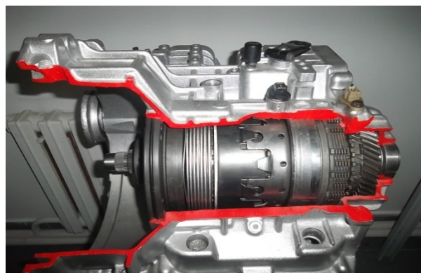
8-сурет. Toyota жеңіл автомобилінің автоматты беріліс қорабының қимасы
