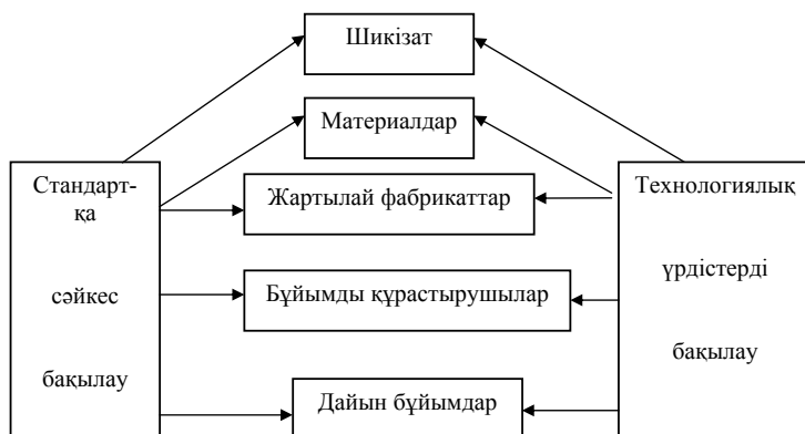
9.3-сурет. Бұйымды өндіру үрдістеріндегі сапаны бақылау сұлбасы
