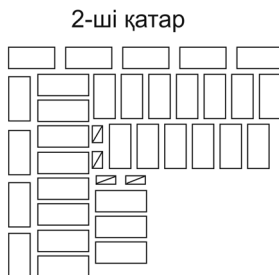
24-сурет. Қалыңдығы 2 (а) және 2,5 (б) кірпіш қабырғаларды байланыстырудың бір қатарлық жүйесі бойынша бұрыштарды қалау
