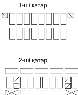
24-сурет. Қалыңдығы 2 (а) және 2,5 (б) кірпіш қабырғаларды байланыстырудың бір қатарлық жүйесі бойынша бұрыштарды қалау
