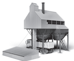
67-суретте СЗШ-8-і бар, өнімділігі 10 т/сағ, КЗС-10 Ш комплексінің шахталы кептіргіші көрсетілген
