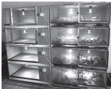
51-сурет. Лампылары бар электр брудерлерді ауылдың құс фермасында орналастырудың тәртібі
